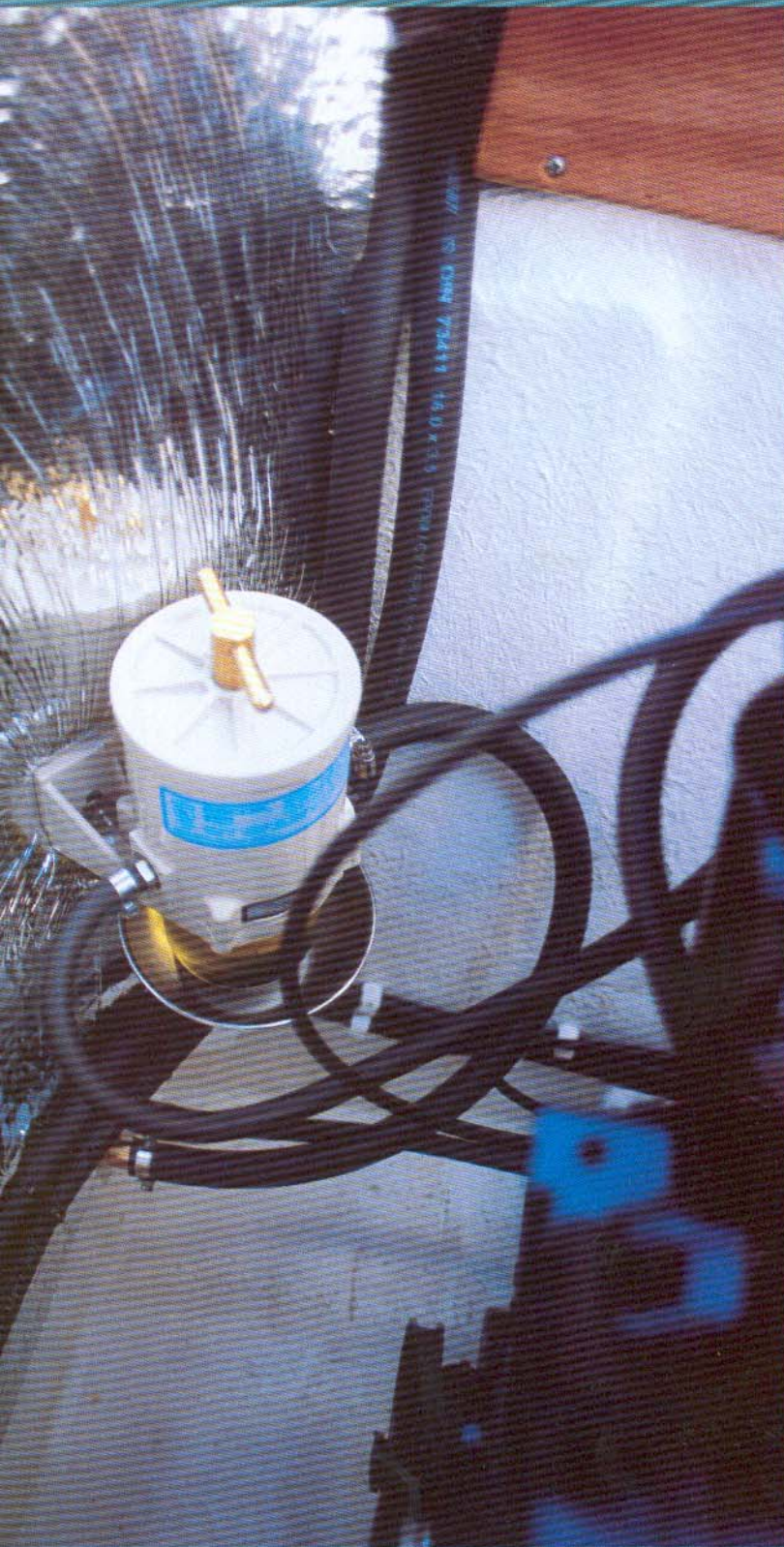
Et specielt vandudskilningsfilter for dieselmotorer bør af sikkerhedsgrunde monteres. Prisen på filtret er ca. 1600 kr.
