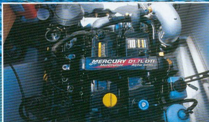
Den nye 4-cylindrede diesel på 116 hk er en smule større end den tilsvarende benzinmotor.
